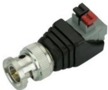
Este tipo de conector se destaca porque ao invés de parafusos, a conexão do cabo é feita por bornes de pressão, que mantêm constante a conexão entre o cabo e o conector, sem o risco de se afrouxar, como acontece com o conector de borne de parafuso.
